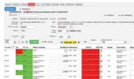
Slika 4: Ob vnosu meritev delavec sproti vidi izračunan trend CPK spremembe; zelena puščica nakazuje, da se približujemo sredini, medtem ko rdeča puščica nakazuje, da se oddaljujemo. Zelena barva v 3. stolpcu sicer pravi, da je meritev znotraj toleranc; vendar je že veliko meritev izven kritične Delta, kar pomeni, da če se bo negativen trend nadaljeval, bo lahko kmalu preveliko odstopanje.
