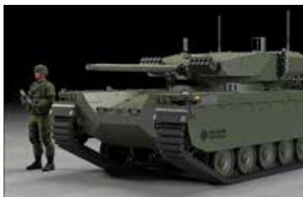
Vojaško vozilo Type-X Robotic Combat Vehicle lahko povsem samodejno opravlja vojaške naloge.
